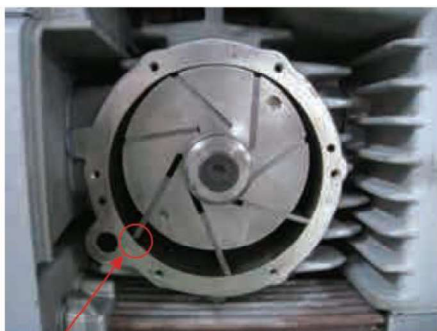
Неправильный монтаж лопастей (поз. 11)
