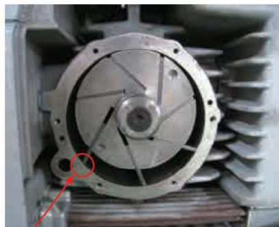
Правильный монтаж лопастей (поз. 11)
