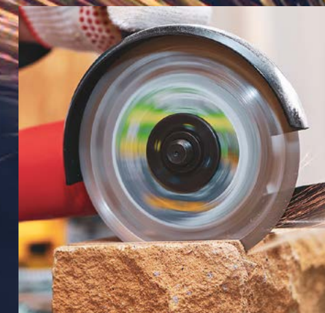
Часто предназначение диска можно понять по цвету: синий — для металла, зелёный — для бетона
